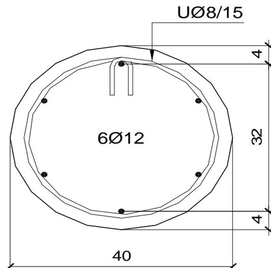
8. Za presek iz Primera 1 odrediti napone u betonu i armaturi, vodeći računa o dugotrajnom dejstvu stalnog opterećenja. Usvojeno:  $\varphi_\infty = 2.5$ ;  $\chi_\infty = 2.5$   $\epsilon_{s_\infty} = 0.4\%$ .
