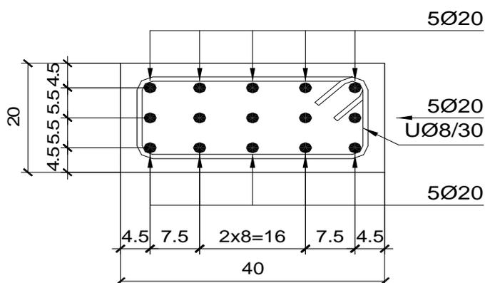
7. Odrediti napone u betonu i armaturi za presek prikazan na skici desno. Presek je opterećen silama pritiska  $N_g = 630$  kN i  $N_p = 398$  kN. MB 25, GA 240/360.
